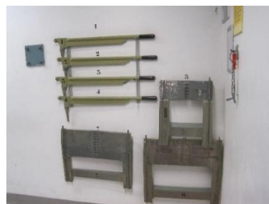
Figura 4: Útiles para la extracción de interruptores de la barra "A" de 4,16 kV.
